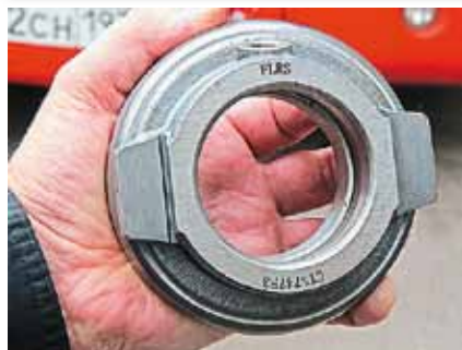
В муфте важна не только геометрия, но и качество подшипника
