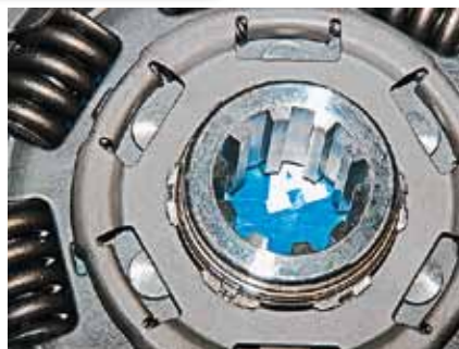
От точности и качества нарезки шлицов зависит легкость хода диска на валу
