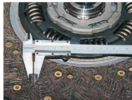
Перед монтажом сцепления мы проверили посадку заклепок во фрикционных
